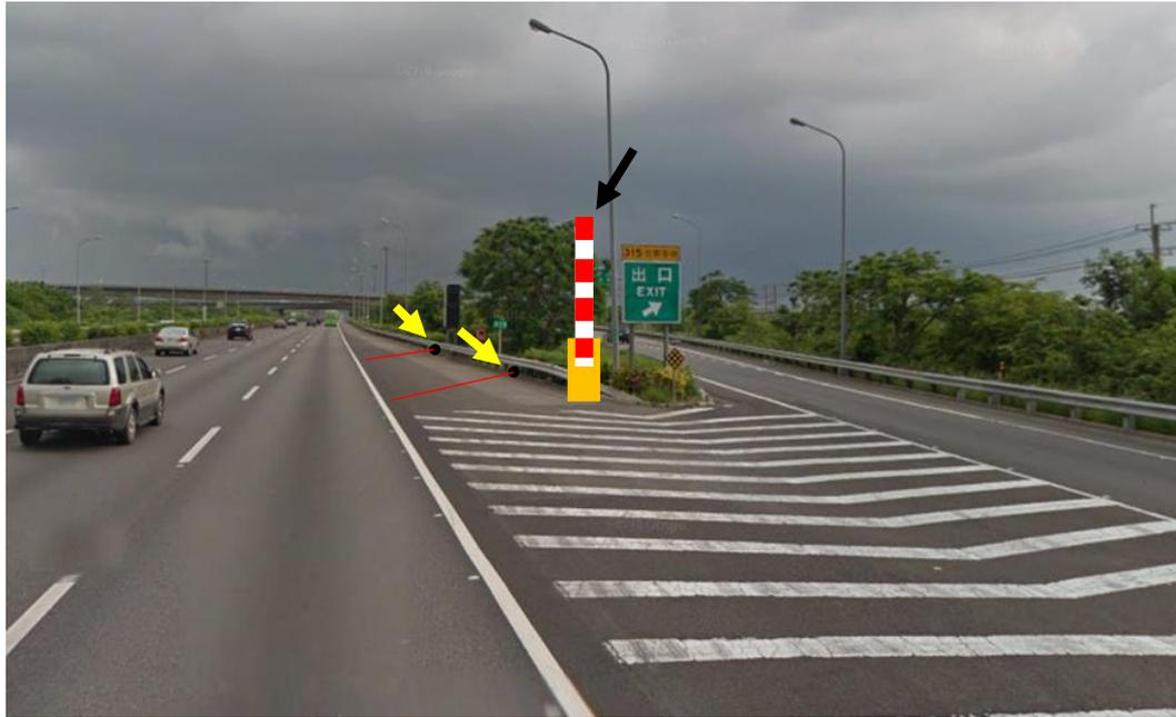
圖 1.紅外線感測器安裝於已過交流道口的路肩護欄上(黃色箭頭處)
